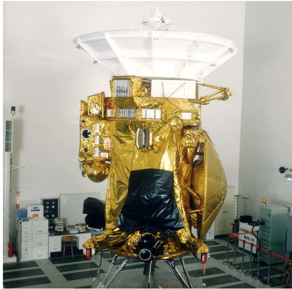
Bild 1: En testmodell av Cassini på marken (källa: NASA)
